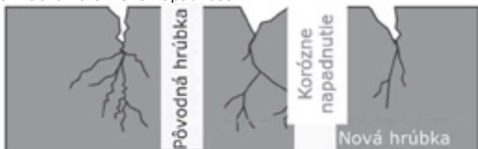
Schematické znázornenie korózneho napadnutia ocele
