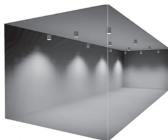
Obr. 1 Na tomto obrázku vidíme, že bolo potrebné použiť 12 svietidiel pre priestor 10x20 s výškou 8 metrov, pre 500 lx.
