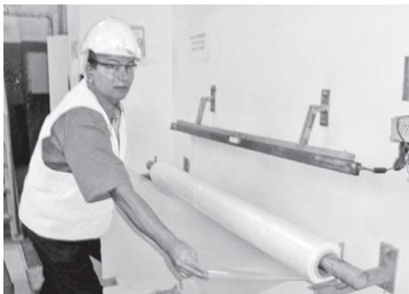
Obr. 5: Po nainštalovaní ionizačných lišt sa fólia jednoducho odvíja a obsluha nedostáva silné elektrické výboje a šoky.
