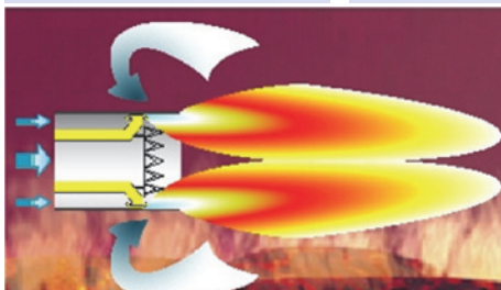
Obr. 6 zpětná recirkulace spalin uvnitř spalovací komory
