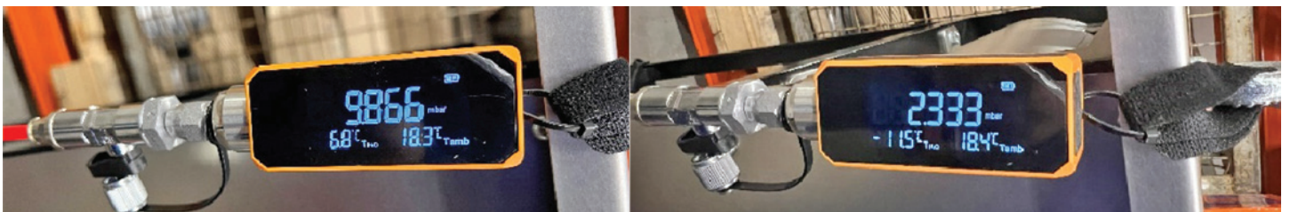
Foto č. 1: Meranie vákuua vizualizáciou teploty odparovania vody, (zdroj: ECOFIL)
