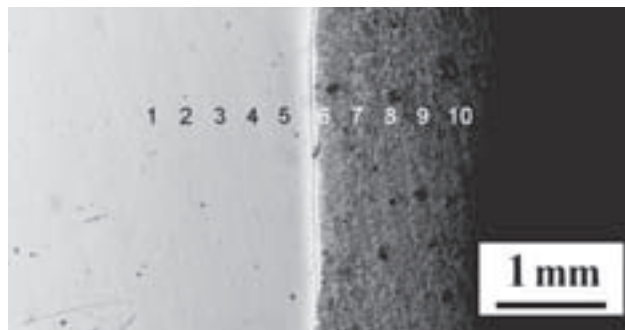
Obr. 4 Mikroštruktúra laserového návaru prídavný materiál zmes CS 52+ 30% CrB2 -TiB2 [7]
