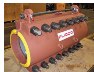
Obr. 12 Delená oceľová objímka po obnove
