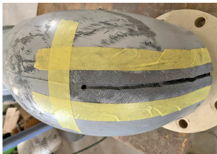
Obr. č. 7 PVC potrubie s pripraveným povrchom na zalepenie, so zväčšením praskliny do tvaru „V“ a ukončenou prasklinou zavŕtaním
