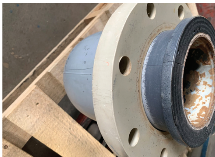
Obr. č. 6 PVC potrubie s prasklinou
