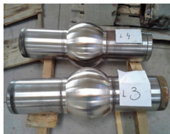
Oprava ložísk horných vrát
