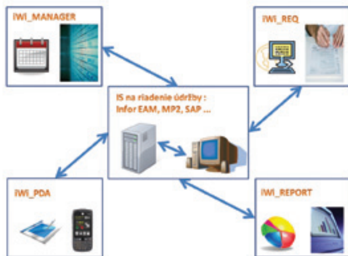
Obr. 2: Prepojenie modulov IWI na nadradený IS
