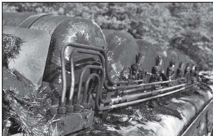
Pohľad na tlakové nádoby na CNG umiestnené na streche autobusu
