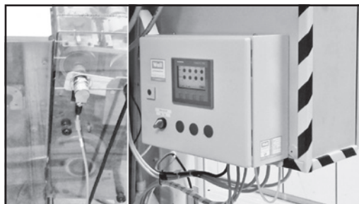
Obr. 1: Na mieru vytvorené riešenie kontroly jadra produktu. Systém detekuje začiatok, dĺžku produktu, obsahuje riadenie vyhadzovania zlých produktov
