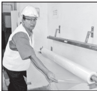
Obr. 5: Po nainštalovaní ionizačných lišt sa fólia jednoducho odvíja a obsluha nedostáva silné elektrické výboje a šoky.
