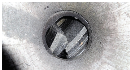
Obr. 7: Pohľad do kompresora cez sanie kompresora, pohľad endoskopom do oblasti 1. obežného kola.
