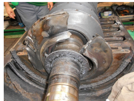
Obr. 10: Poškodenie OK a vstupnej medzisteny
