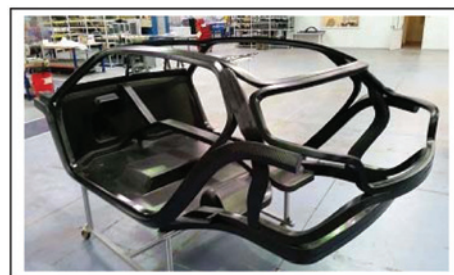
Obr. 3.: MATERIÁL – Budúci automobil bude mať samonosnú karosériu z uzavretých slučiek z CFRP (plasty zosilnené karbónovými vláknami), spojené do štruktúry lepením [Zdroj: Koncept „Hyundai Intrado Crossover“, WMS2018]
