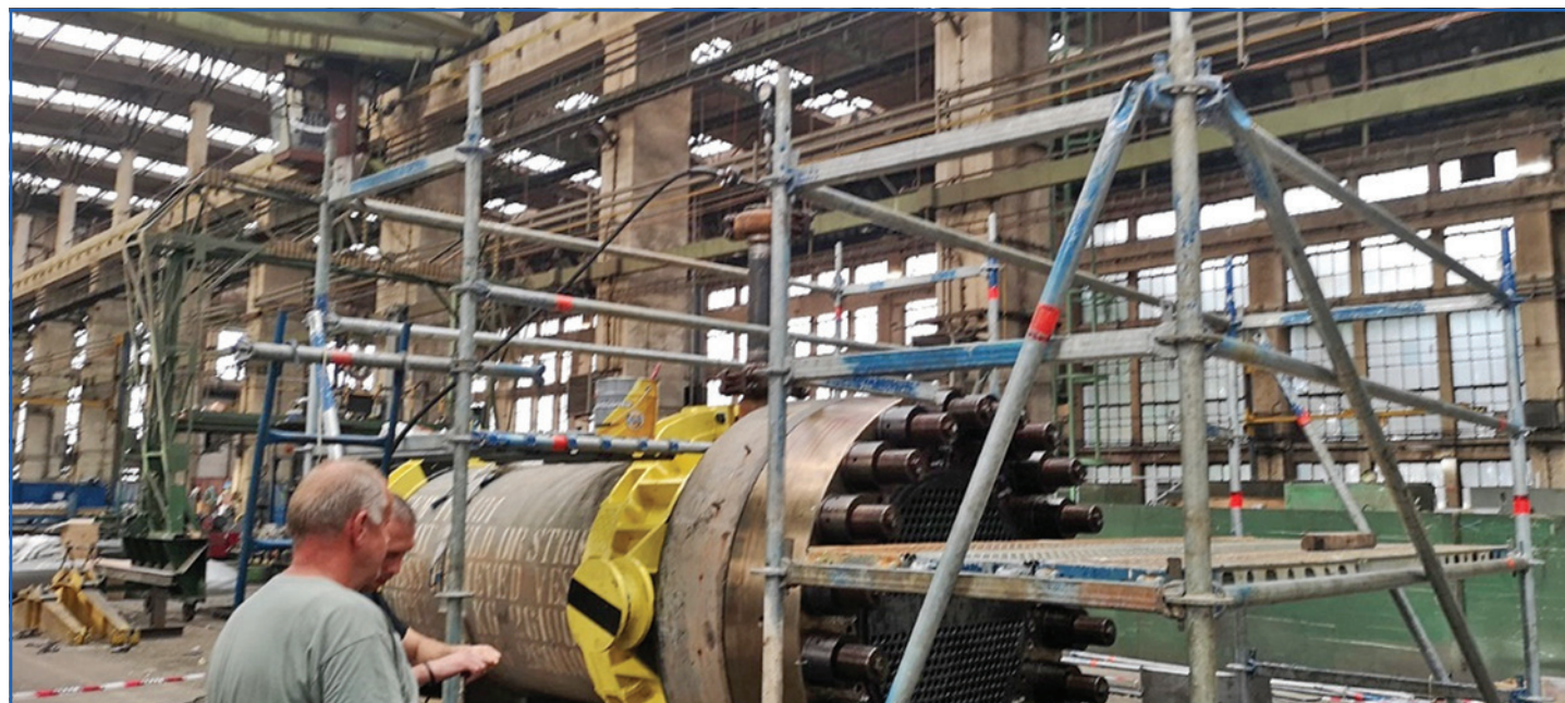
Príprava na tlakovú skúšku
