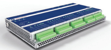
Obr. 6: Mimoriadne zaujímavým riešením je VCM-3, má 12 vibračných vstupov a zabudovaný WEB server
