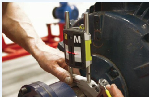
Obr. 7: Prístroje na laserové nastavenie súosovosti s čiarovým laserom s dĺžkou 30 mm a prístroj na meranie „nekruhovitosti“ (Run Out) alebo „hádzavosti“.
