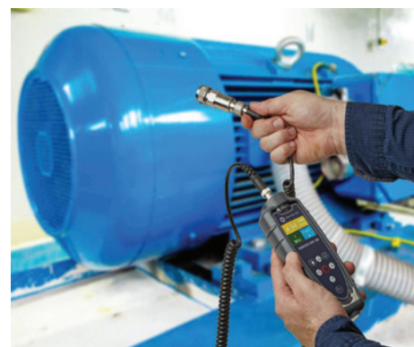
Obr. 5: VST 80 a VIBROPORT 80 využívajú najmodernejšiu technológiu s farebnou zobrazovacou jednotkou, môžu byť dodané aj pre Ex prostredie (ATEX certifikované), a sú podporované výkonným programom REO pre PC.
