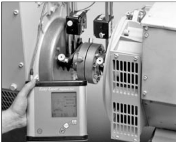
Systém Easy-laser pre ustavovanie spojok.
