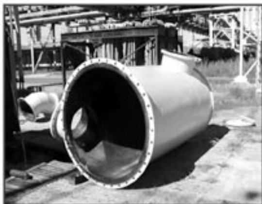
Izolace vnitřní části technologického zařízení a podlahy stříkací věže.
