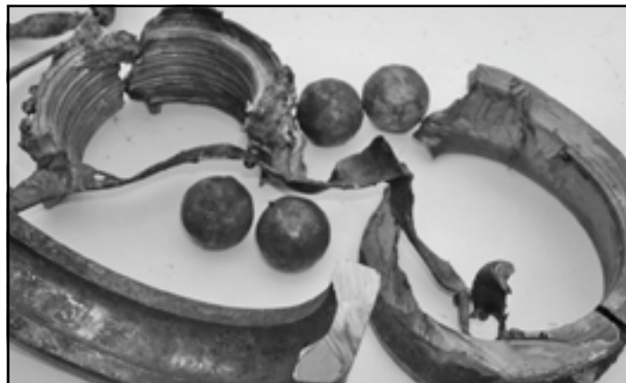
Montážna chyba – malý presah, pretáčajúce sa púzdro.
