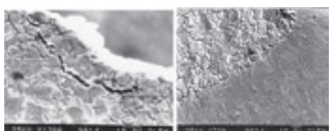
Obr.12 Mikrosnímka povrchu dosky odparníka v okolí perforácie
