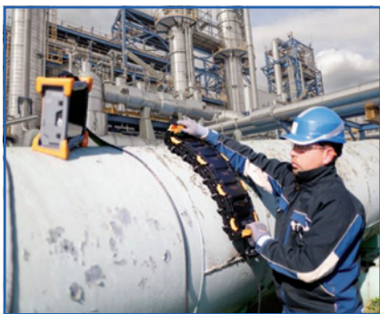
Obr. 1 Meranie (skenovanie) korózie pod izoláciou
