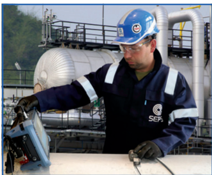
Obr. 2 Mapovanie korózie (Phased Array)
