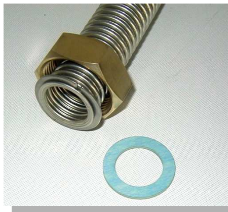
Zatvorenie krúžku a vloženie tesnenia – hadica s koncovkou je pripravená na montáž
