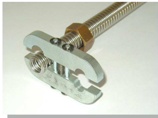
Rozlisovanie poslednej vlny pomocou svoriek a ručného lisu
