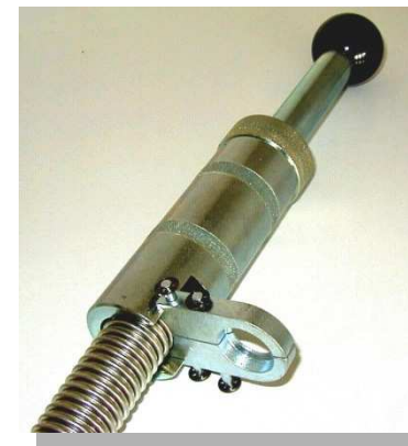
Rozlisovanie poslednej vlny pomocou svoriek a ručného lisu
