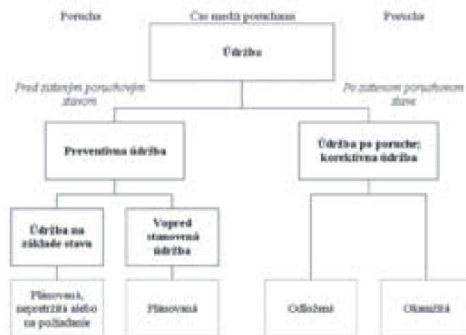
Obr. 2 Základné typy údržby podľa normy STN EN 13306
