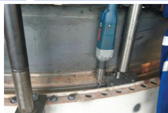
Frézovanie za pomoci „pojzdového vláčika“
