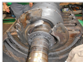
Obr. č. 6 – Pre pripomenutie – zaznamenané poškodenia na komponentoch kompresora
