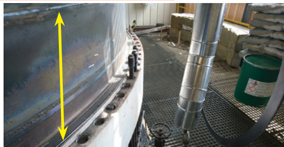
Obrábacie miesto sa nachádzalo skoro 450 mm pod okrajom vrchu reaktora a vzdialenosť okraja drážky od steny reaktora len 20 mm
