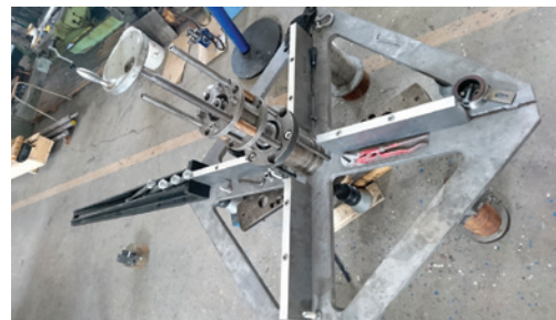
Obrábací stroj spoločnosti SLOVCEM s dosahom na priemer 3 000 mm sa zvýšením ramien prerobil na priemer 4 150 mm. V dielni spoločnosti SLOVCEM sa vykonalo zloženie stroja, odskúšanie frézovania a späťné rozloženie stroja
