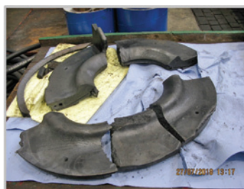
Obr. č. 6 – Pre pripomenutie – zaznamenané poškodenia na komponentoch kompresora
