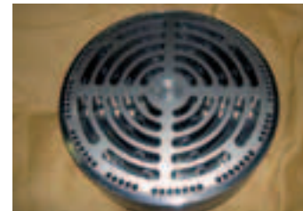
(obr. 7.3: Sací ventil – Upravená konštrukcia)
