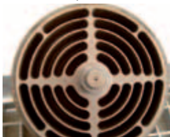
(obr. 7.1: Sací ventil – Pôvodná konštrukcia)
